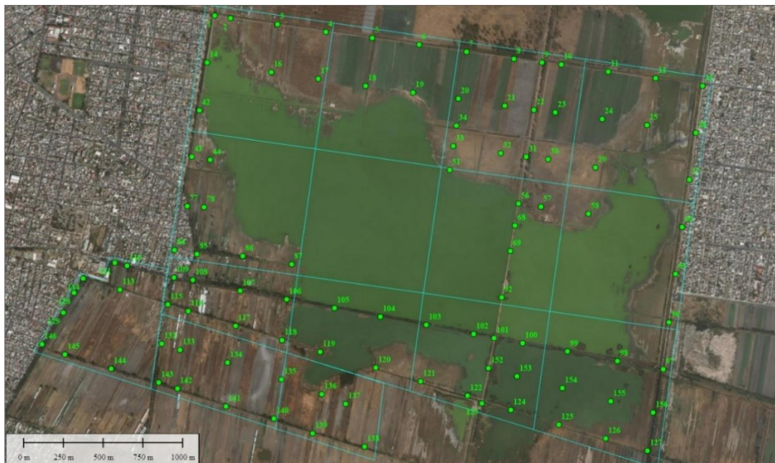
Figura 31. Puntos de verificación de los vuelos fotogramétricos.
