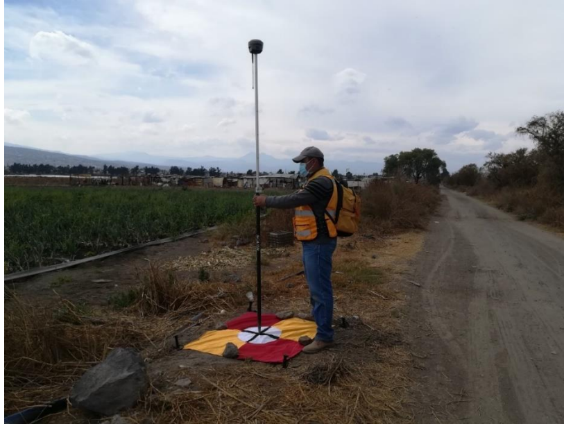
Figura 30. Levantamiento de puntos de control en la cobertura del vuelo 2.
