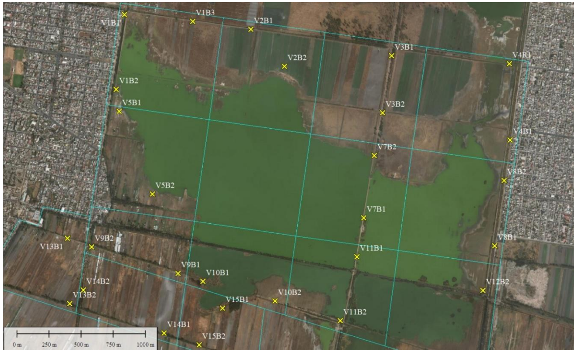
Figura 29. Ubicación de los 29 puntos de control del levantamiento fotogramétrico.
